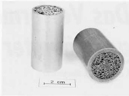
Abb. 3: Aluminiumprofil (AlMgSi0.5) mit Füllung aus Aluminiumschaum (AlSi6Cu4)
