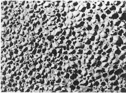
Abb. 2: Ansicht der Porenstruktur eines Metallschaumes (Bildausschnitt  $30 \times 20$  mm)
