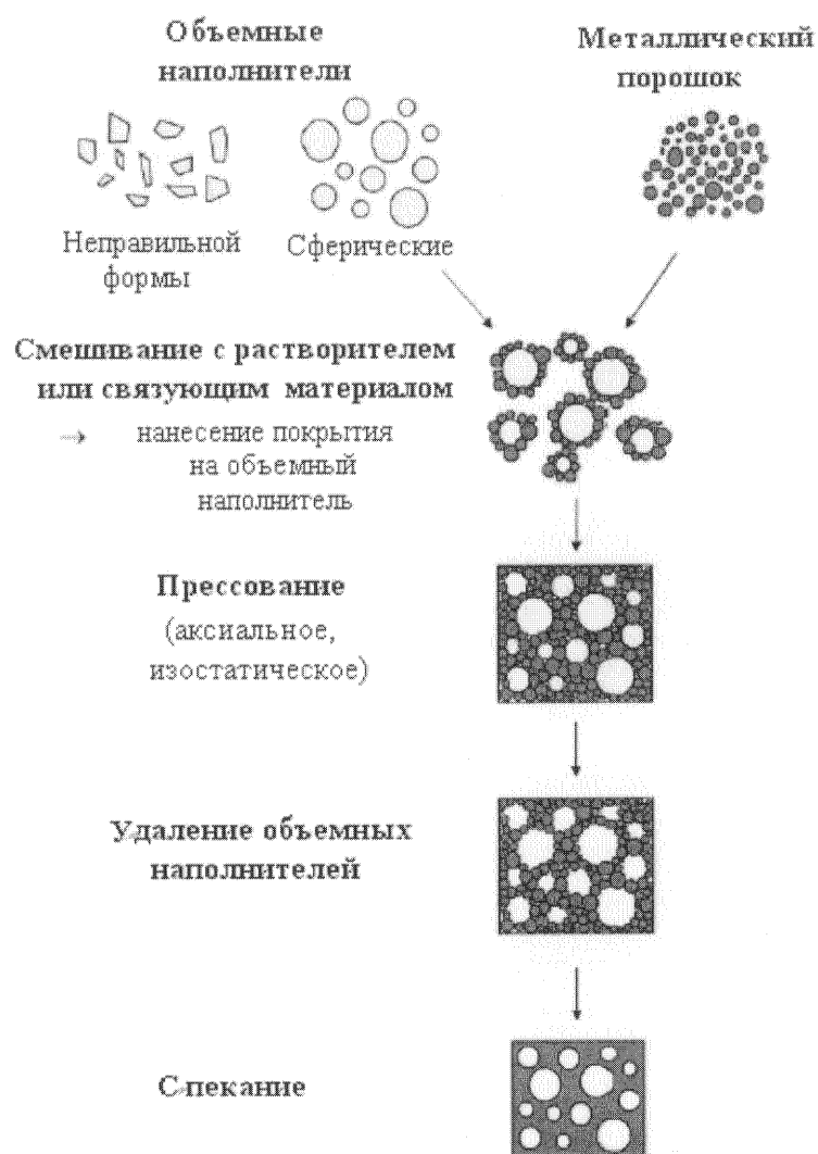
Рис.28. Метод получения пористых металлических структур из порошка металла с использованием объемных наполнителей (использована схема из работы [213])
