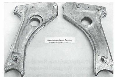
**Bild 3: Formteile aus Aluminiumschaum**
